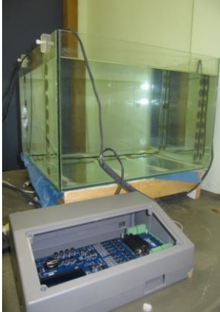
Figura 10: Placa de aquisição de dados e tanque utilizados para o ensaio.
