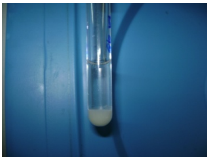
Figura 4 - Precipitação da mucina no tubo de polipropileno, após a centrifugação.
