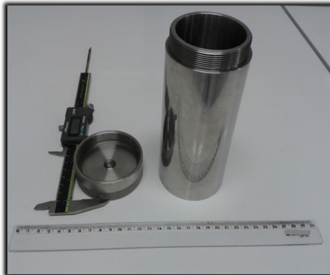
Figura 4.7. Câmara de coleta de gases. A tampa e o corpo formam o conjunto de peças da câmara de coleta.
