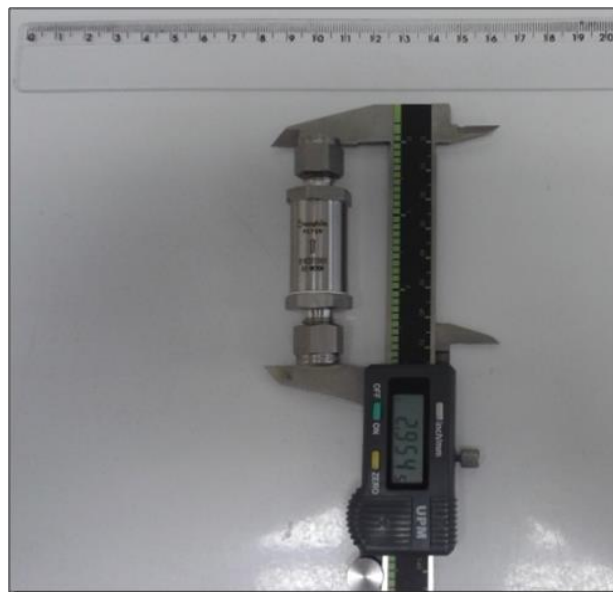
Figura 4.5. Filtro em linha de aço inox série F Swagelok®, para utilização com gases e líquidos, retém partículas finas de alta densidade (esse filtro auxilia na segurança para que nenhum material particulado passe pelo tubo de percolação e pela câmara de coleta e se encontra nas extremidades do tubo de percolação).
