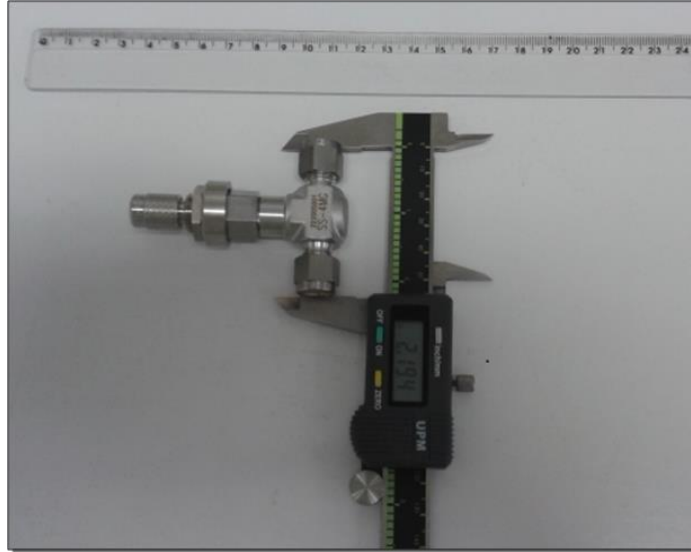
Figura 4.4. Válvula micrométrica Swagelok® com pressão máxima de até 700 psi ou 48,2 bar e faixa de temperatura de -28°C a 482°C. É produzida em aço 316 inoxidável. Uma válvula foi conectada em cada extremidade do tubo de percolação.
