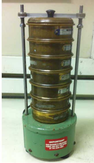
Figura 4.2. Conjunto peneiras vibratórias.
