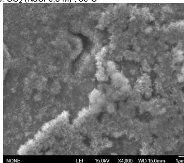
b) Aço API K55, meio: \text{CO}_2 (NaCl-0,5 M) , 50°C
