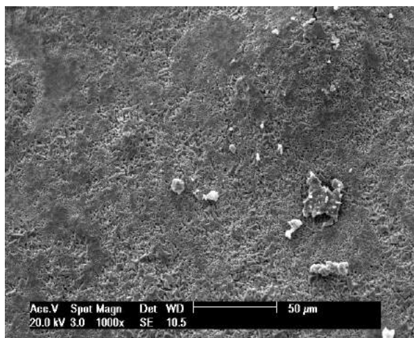
a) Aço SAE 1010, meio: CO 2 (NaCl - 0,5 M), 90°C
