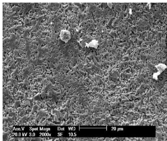
a) Aço SAE 1010, meio: CO 2 (NaCl - 0,5 M), 90°C
