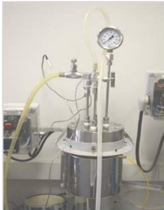
Figura 4.6 - Reator de liga de Titânio utilizado para realização dos experimentos de corrosão a alta pressão de CO 2 .
