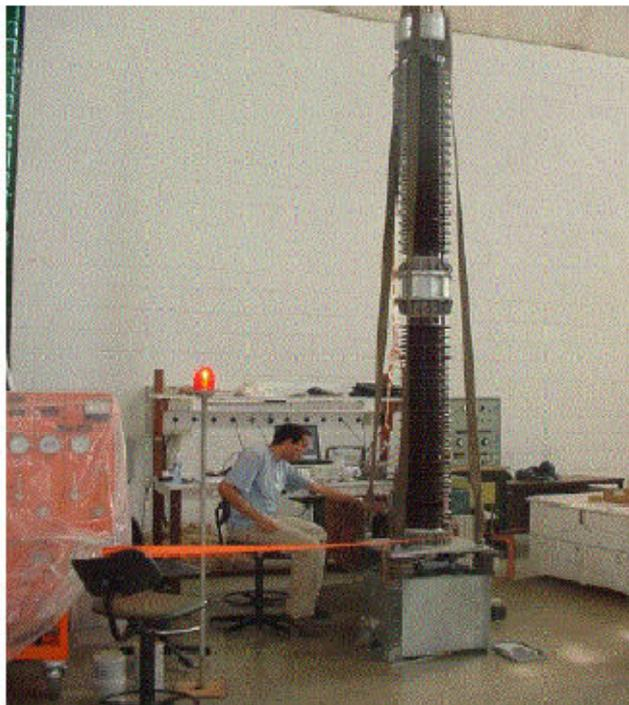
Figura 3.3 – Transformador de Potencial Capacitivo
