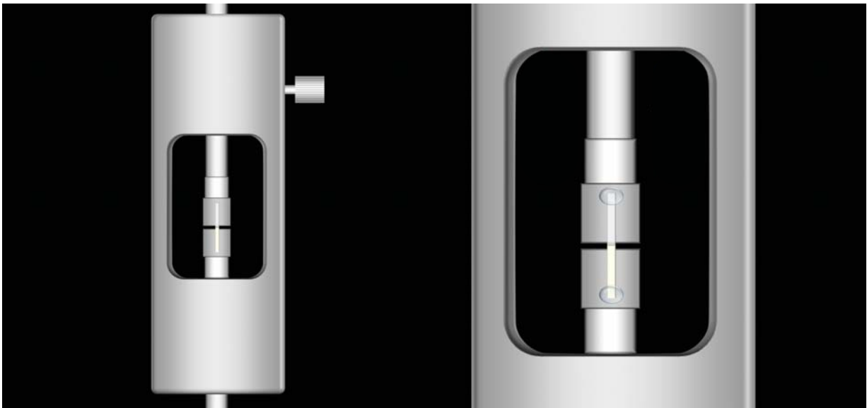
Figura 9. Palito fixado ao dispositivo para ensaio de microtração.
