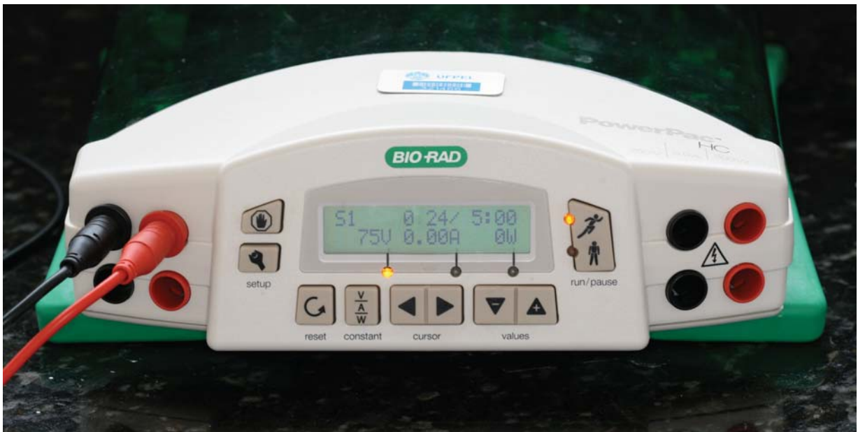
Figura 4 – Dispositivo elétrico para controle de amperagem e voltagem durante a eletroforese (Bio Rad).
