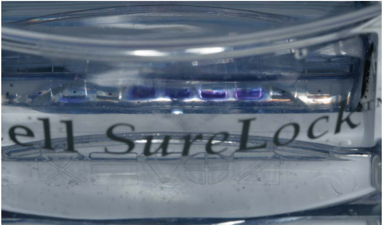
Figura 2 – Amostras/tampão adicionadas aos poços do gel de largada com o auxílio de uma micropipeta, em um volume de 25 \mu l/poço na cuba de eletroforese (X Cell Sure Lock - Invitrogen).
