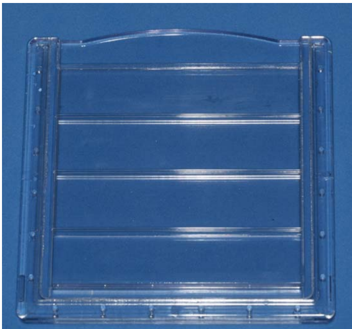
Figura 1 – Matriz plástica descartável de 10cm x 10cm para preparo do gel de largada e de corrida.
