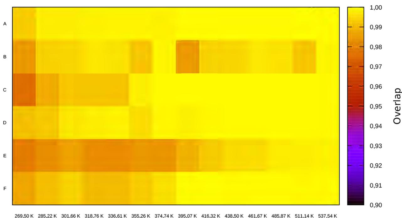
Figura 6.3 – Sobreposição de energia potencial entre triplicatas do mesmo protocolo em função da temperatura das réplicas. Verificação de reprodutibilidade para CuT-REMD e REMD convencional. Na Tabela reftabela-detalhes, podem ser obtidos detalhes sobre os IDs dos protocolos no eixo esquerdo. Valores mais altos simbolizam maior reprodutibilidade.
