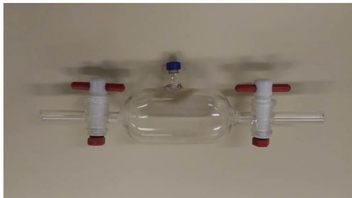
Figura 4.10. Cápsula de gás de 100 mL, utilizada nas diluições.
