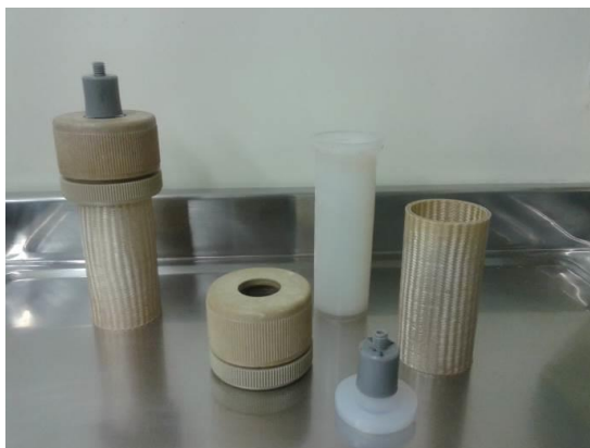
Figura 4.1. Reator fechado (R2) (esquerda) e componentes do reator (direita) .
