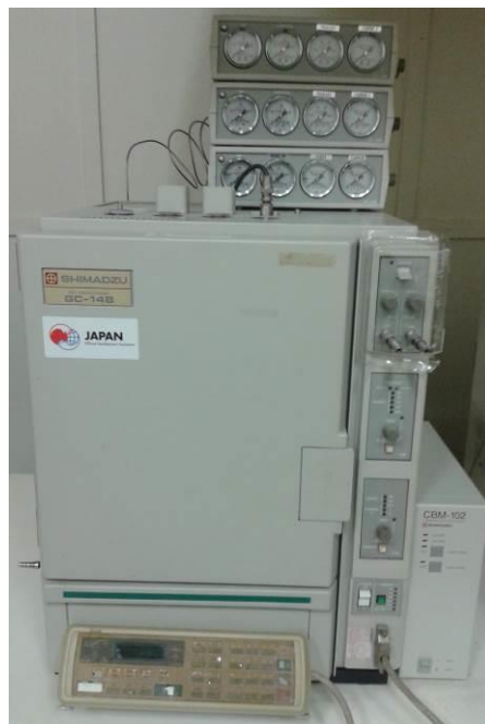
Figura 4.15. Cromatógrafo a gás da marca Shimadzu, modelo GC-14B.
