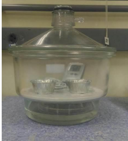
Figura 4.3. Sistema com atmosfera controlada utilizado para os testes de adsorção de umidade.
