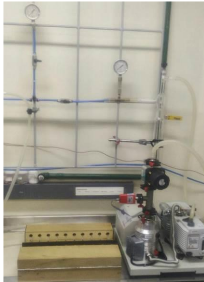
Figura 4.13. Sistema de vácuo utilizado para evacuar os frascos coletores.
