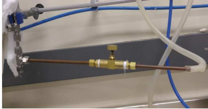
Figura 4.8. Seção para saída de gases + válvula agulha.
