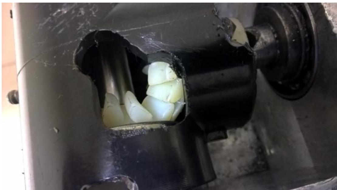
Figura 5.33 - Ensaio dinâmico, Z12 e módulo 4mm no momento do escoamento a 50Nm.
