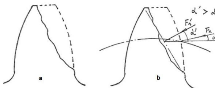
Figura 3.25 - Forma de desgaste típico em engrenagens de acetal. (LI, W. *et al.*, 2011).
