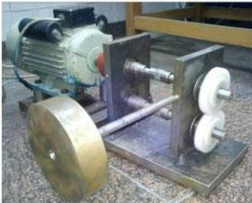
Figura 3.27 – Dispositivo para aplicação de rotação e carga (torque) (Yousef 2013)
