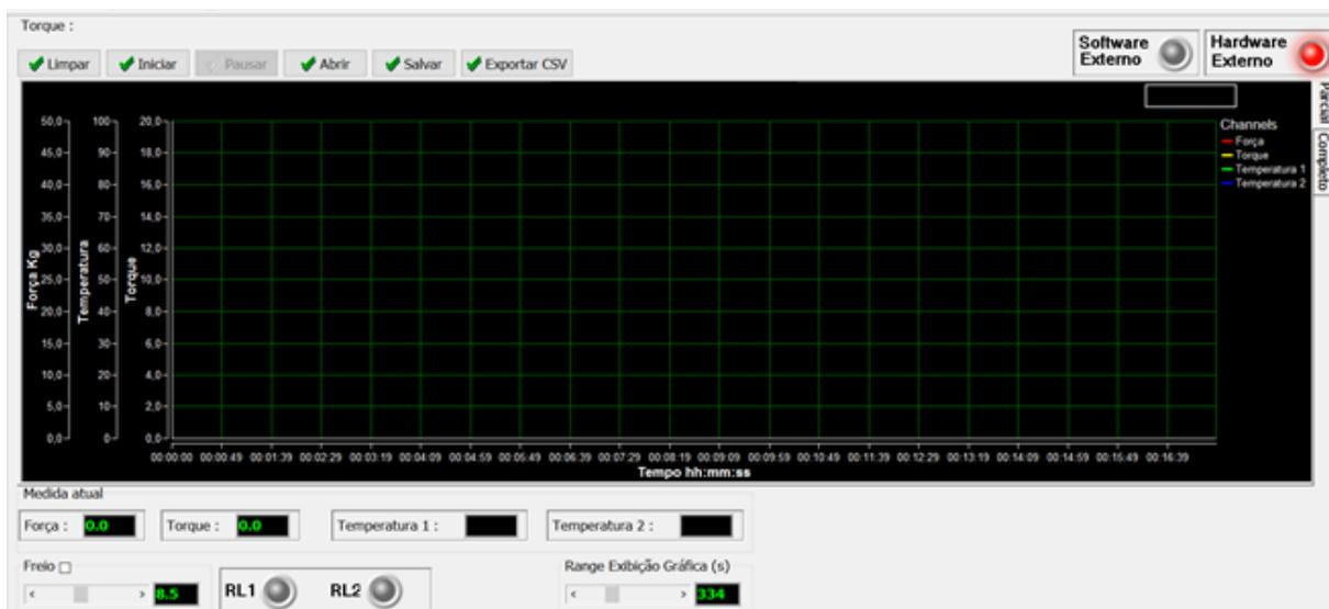
Figura 4.7 - Aquisição de plotagem de dados a partir da célula de carga e termômetro infravermelho
