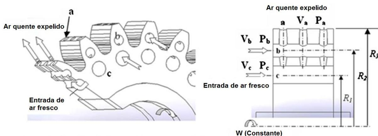
Figura 3.40 – Modelo de engrenagem refrigerada. (DÜZCÜKOĞLU, 2009a)
