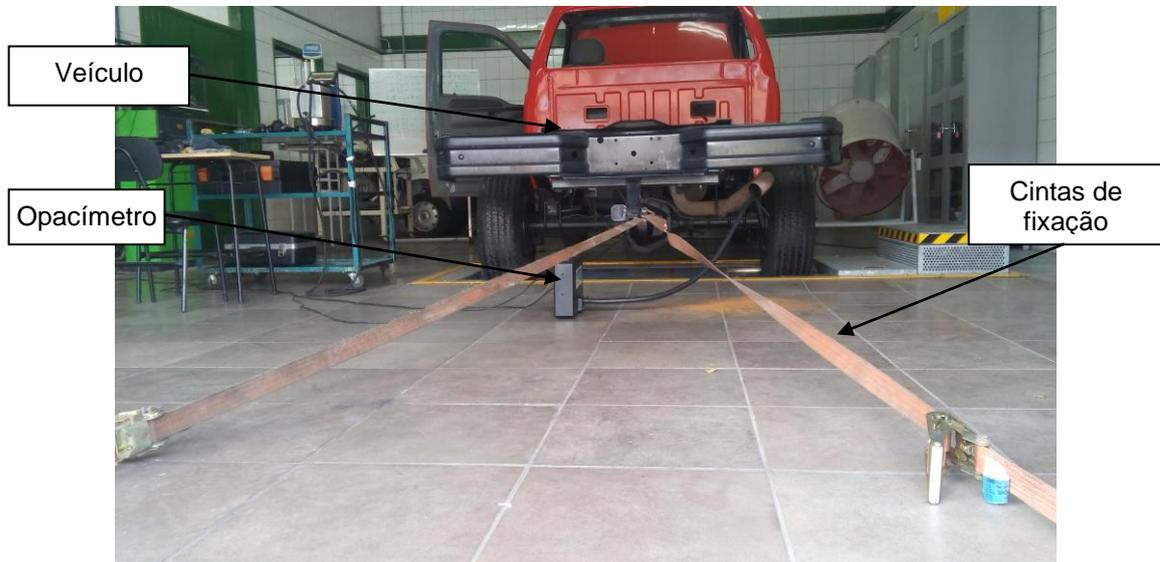
Figura 4.18. Ancoramento do veículo no dinamômetro através de cinta de fixação.
