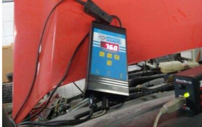
Figura 4.9. Medidor de rotação do analisador NAPRO, modelo Pro 8500.
