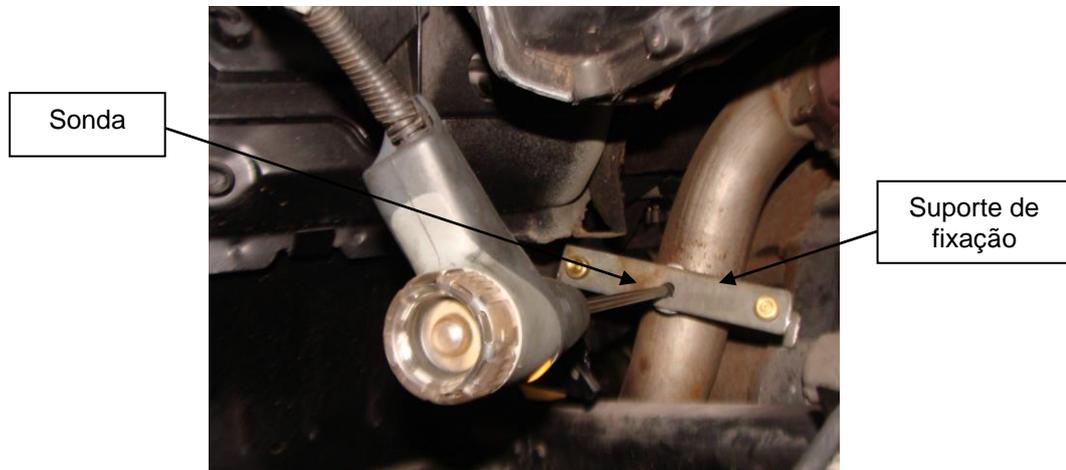
Figura 4.5. Sonda e suporte da sonda do analisador de gases TESTO, modelo 350.
