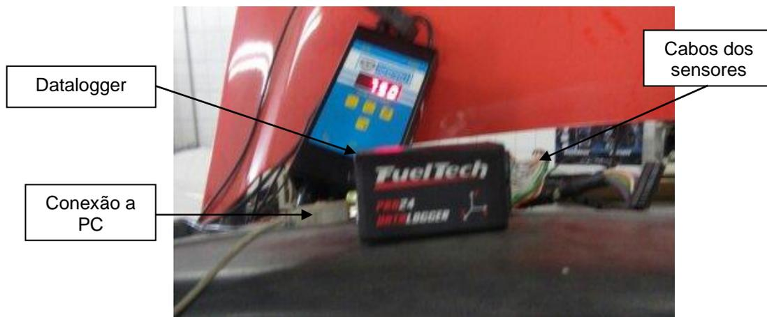
Figura 4.14. Datalogger FUEL TECH, modelo Pro, 24 canais.
