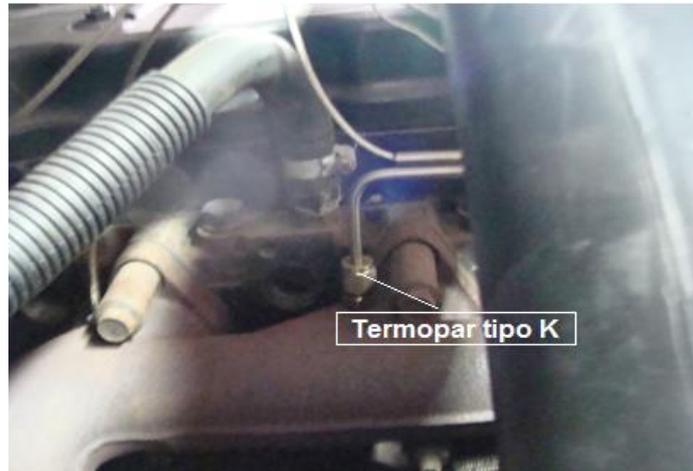
Figura 4.12. Sensores termopares tipo K instalados no coletor de escape.
