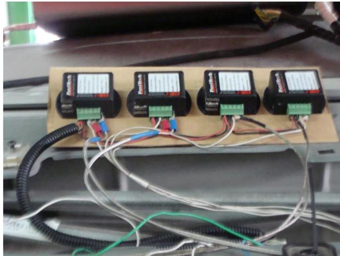
Figura 4.13. Condicionador de sinais de temperatura.
