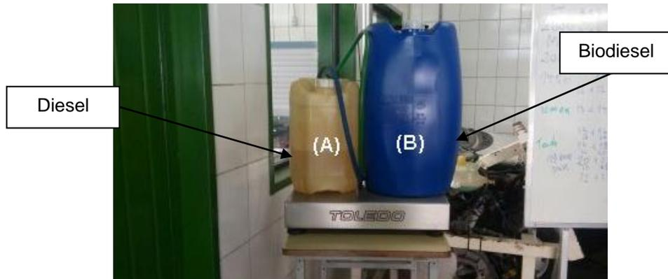
Figura 4.4. Reservatórios de acondicionamento de combustível: (A) reservatório diesel S10; (B) reservatório biodiesel.
