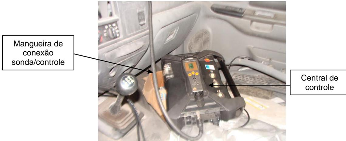
Figura 4.6. Central de controle do analisador de gases TESTO, modelo 350.
