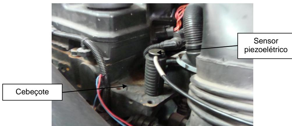
Figura 4.8. Sensor piezoelétrico posicionado sobre o cabeçote do motor.
