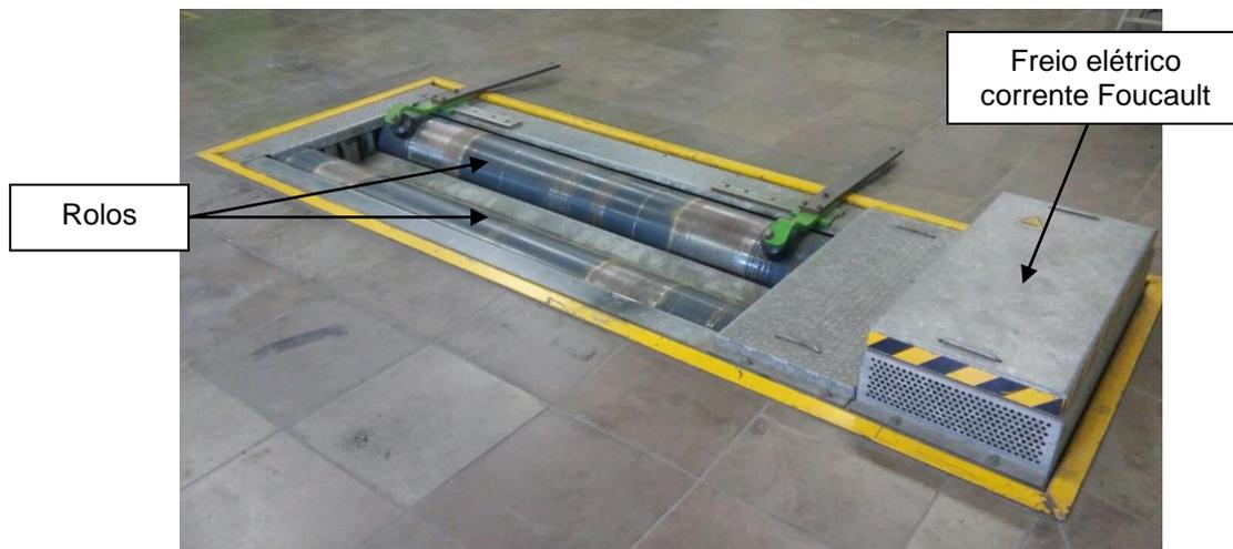
Figura 4.2. Rolos e freio elétrico do dinamômetro BOSCH, modelo FLA 203.
