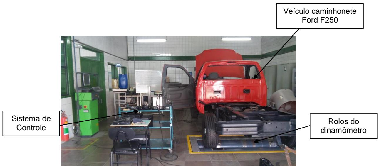
Figura 4.1. Visão geral do ambiente de trabalho, destacando o veículo caminhonete Ford F250, posicionado sobre os rolos do dinamômetro, e os sistemas de controle.
