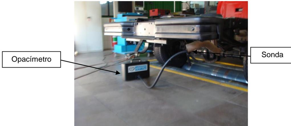
Figura 4.7. Opacímetro NAPRO, modelo NA 9000.
