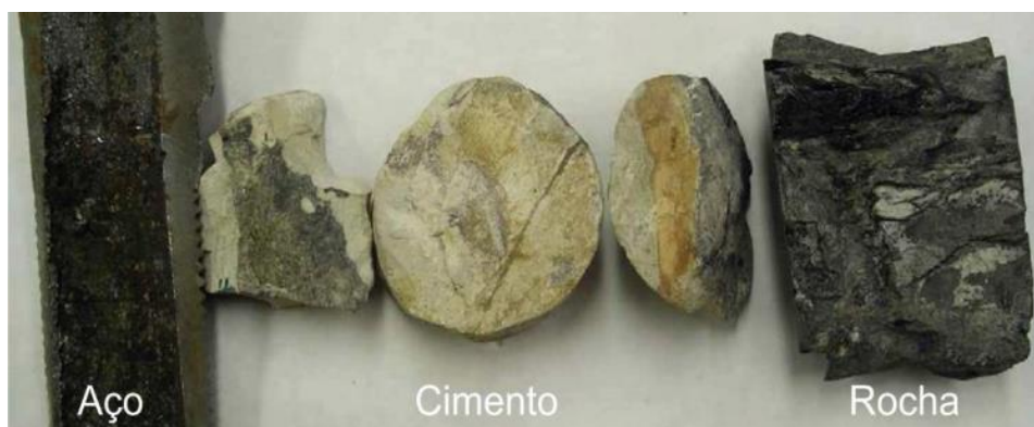
Figura 5.11 - Testemunho de pasta de cimento extraído de um poço da unidade de Sacroc no Texas, EUA, o qual foi exposto ao CO 2 supercrítico por 30 anos (Carey et al. , 2007).
