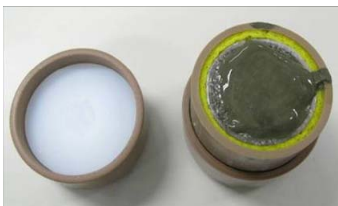
Figura 6-8 - Cimentação do espaço anular.
