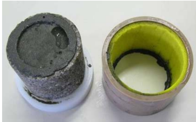
Figura 6-10 - Desmoldagem do corpo de prova após a cura térmica.
