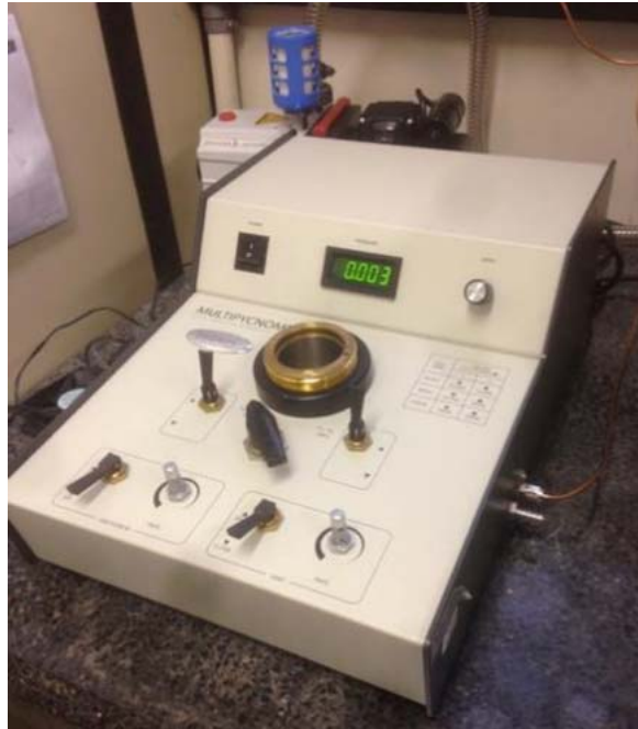
Figura 6-18 - Pícnômetro utilizado para determinação da densidade das amostras de rocha e cimento antes e após exposição ao \text{CO}_2 por 28 e 180 dias (Laboratório de Operações Unitárias- PUCRS, 2017).
