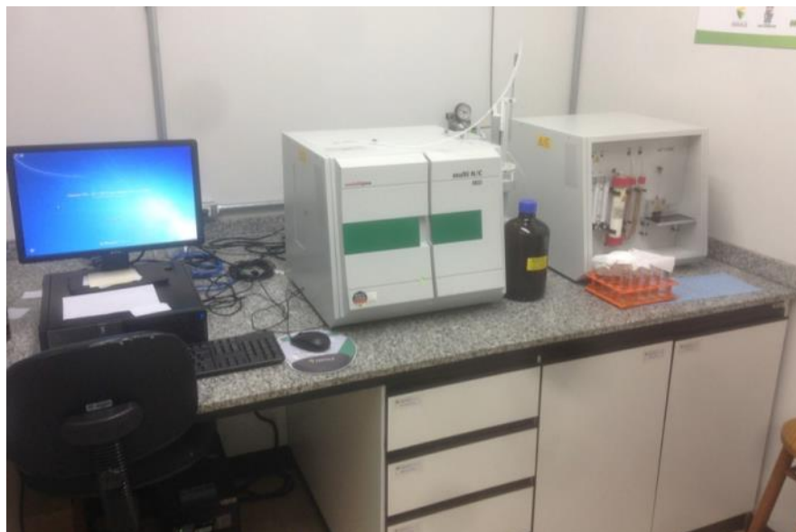
Figura 6-20 - Equipamento para análise elemental de Carbono (Laboratório de Estudos Avançados em Materiais, Universidade Feevale, 2017).
