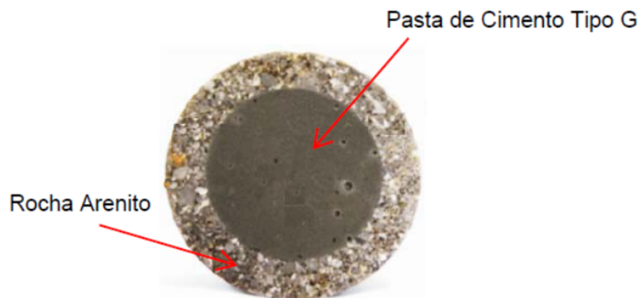
Figura 6-12 - Vista frontal do corpo de prova rocha Arenito / Pasta de Cimento.
