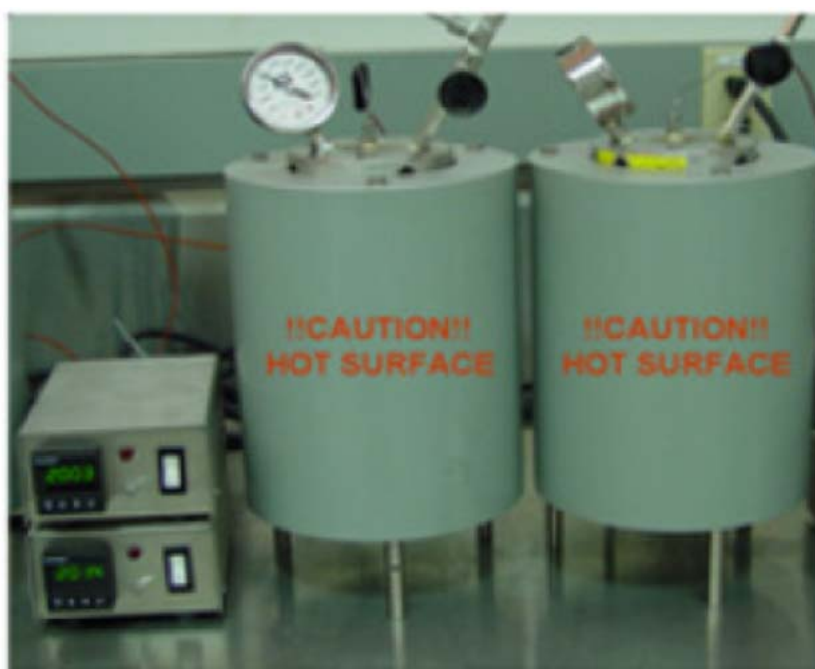
Figura 5.22 - Células de teste estático usados para a realização dos ensaios de degradação do cimento em presença de rocha com CO 2 supercrítico (Santra e Sweatman, 2011).
