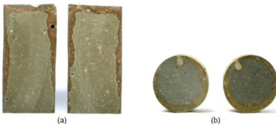
Figura 5-1 - Seção longitudinal (a) e transversal (b) dos corpos-de-prova de pasta de cimento após ensaios de degradação durante 14 dias em água saturada com CO 2 a 70°C e 15 MPa (Dalla Vecchia, 2009).
