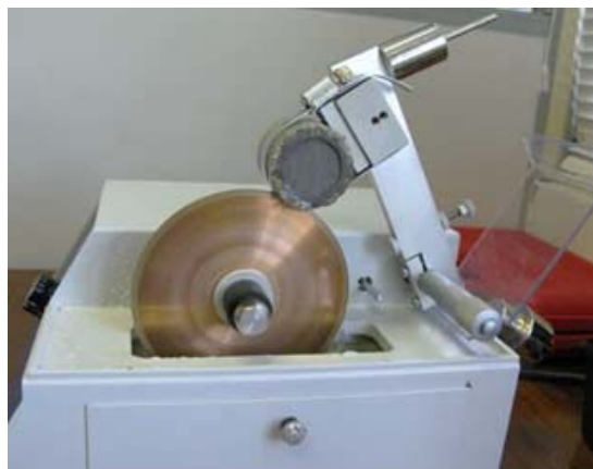
Figura 6-11 - Corte da face superior e inferior dos corpos-de-prova em serra de precisão para regularização da superfície.
