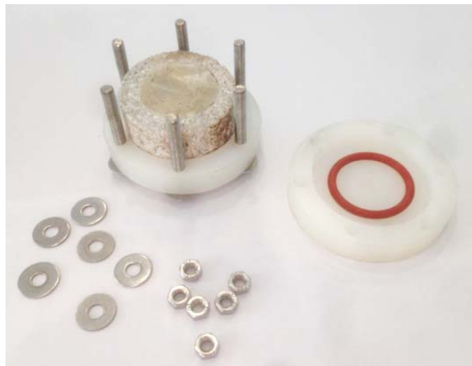
Figura 6-14 - Imagens ilustrando a montagem final do corpo de prova para os ensaios de degradação.
