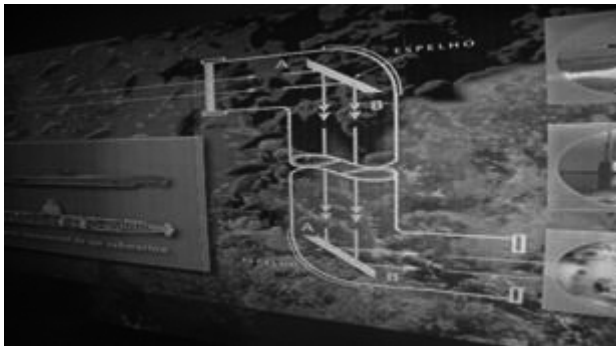
Figura 4: Vista interna do periscópio dentro do MCT/PUCRS.
