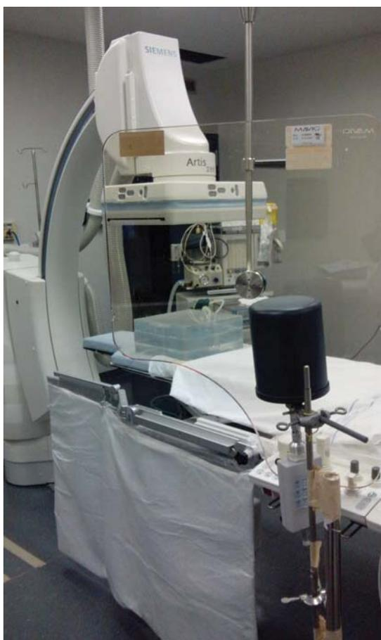
**Figura 1.** Posicionamento da câmara de ionização na posição do medico intervencionista na altura do tórax.
