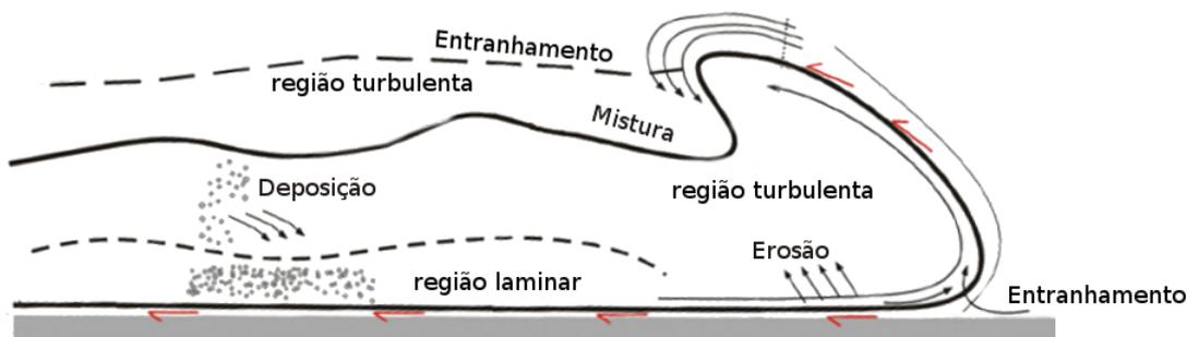
Figura 3.3 – Regiões de uma corrente de turbidez. É possível identificar onde ocorrem os processos de mistura, erosão e deposição e como os mesmos estão relacionados às regiões de turbulência e regime laminar. Fonte: Adaptado de Gladstone e Sparks (2002).
