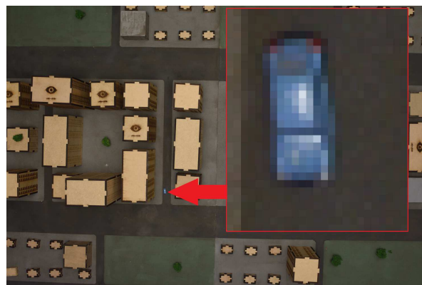
(b) Carro de 24mm, representado por 19 pixel, gerando uma imagem com GSD de 25,2cm.
