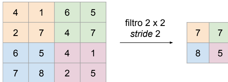
Figura 2.5 – Max Pooling com filtro 2x2 e stride =2. Adaptado de [Uni17].
