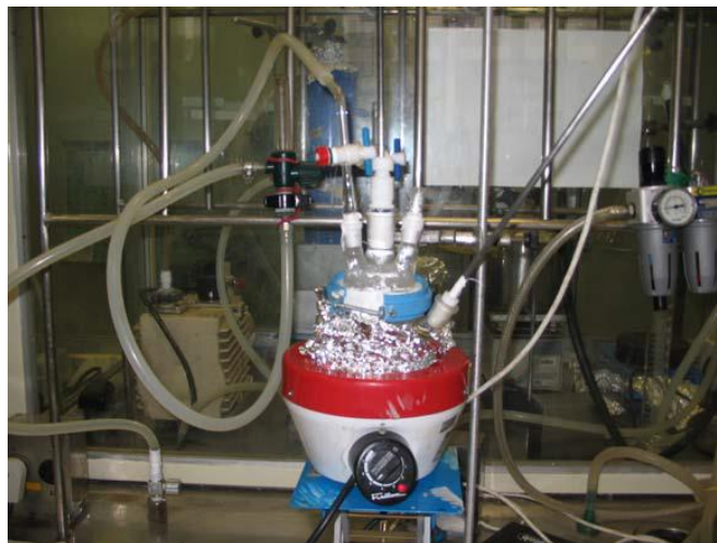
Figura 3: Montagem utilizada para a síntese dos copolímeros de PET- co -PLLA.
