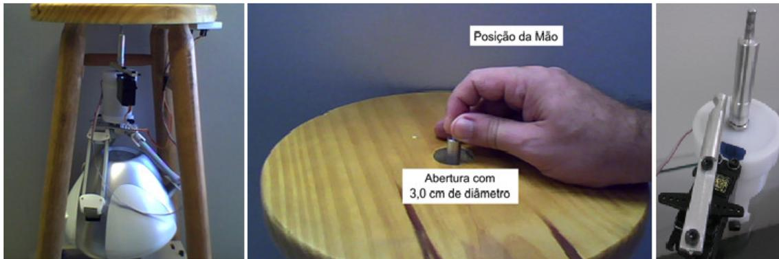
Figura 1 – Na esquerda o dispositivo háptico, no centro o suporte para a mão do usuário e na direita o mecanismo de rastreamento e freio do giro da lima
