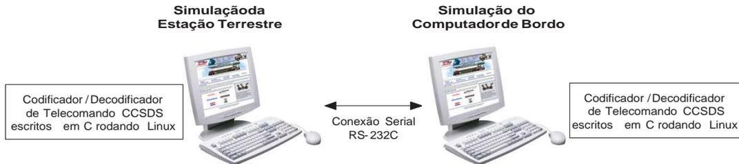
Figura 8.8: Codificador/Decodificador BCH CCSDS escrito em C, transferindo dados entre dois PCs Linux
