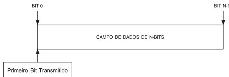
Figura 7.2: Convenção utilizada para numeração dos bits
