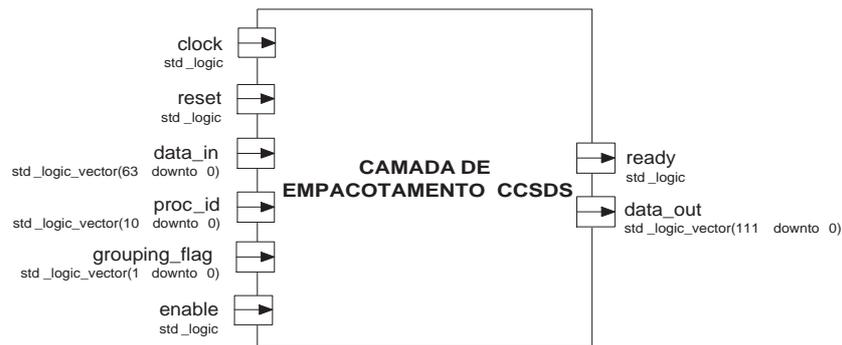
Figura 8.1: Entidade da camada de empacotamento de telemetria CCSDS
