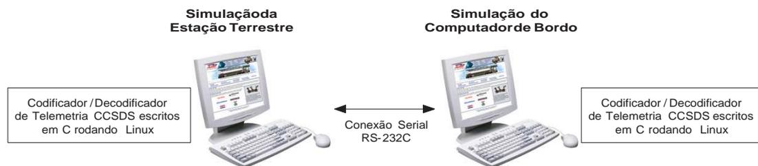
Figura 8.5: Codificador/Decodificador RS CCSDS escrito em C, transferindo dados entre dois PCs Linux
