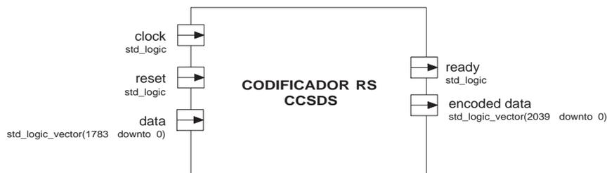
Figura 9.1: Interfaces de entrada e saída do circuito codificador RS CCSDS
