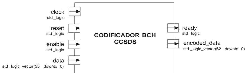
Figura 9.7: Interfaces de entrada e saída do circuito codificador BCH CCSDS
