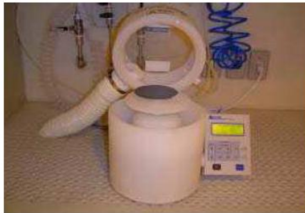
Figura 3.3. Equipamento spinner utilizado na técnica de spin-on para deposição do líquido com boro PBF20 sobre as lâminas de silício.
