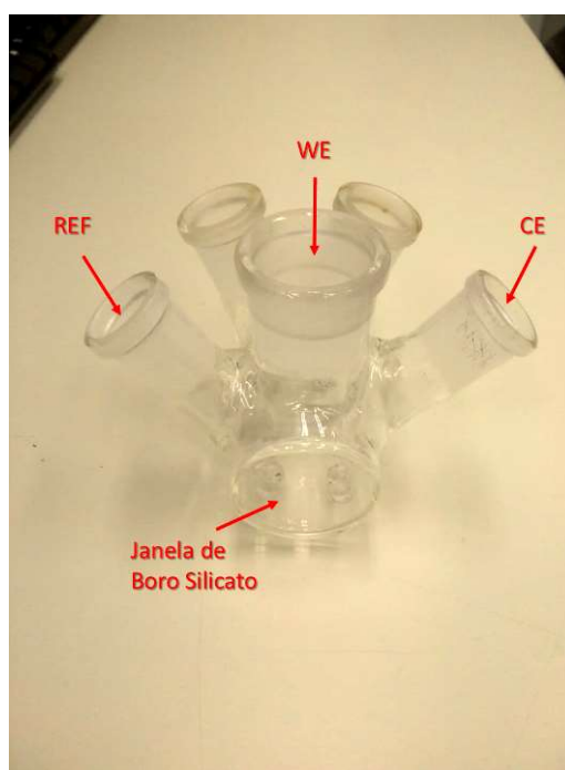
Figura 4.4. Reator eletroquímico com indicação das posições dos eletrodos de referência (REF), e de trabalho (WE), do contraeletrodo (CE) de Pt, e da janela de boro silicato.
