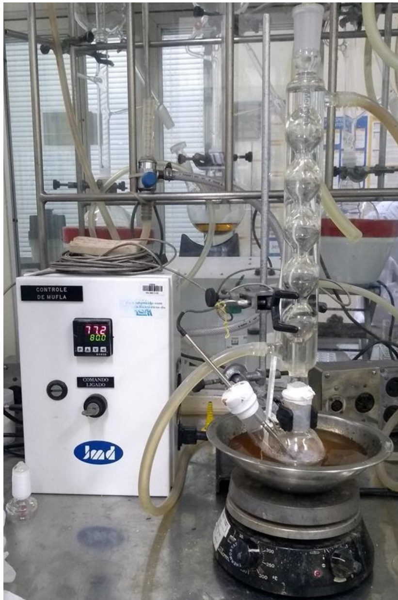
Figura 4.2. Sistema de síntese empregado para a produção de GC, por vía indireta.
