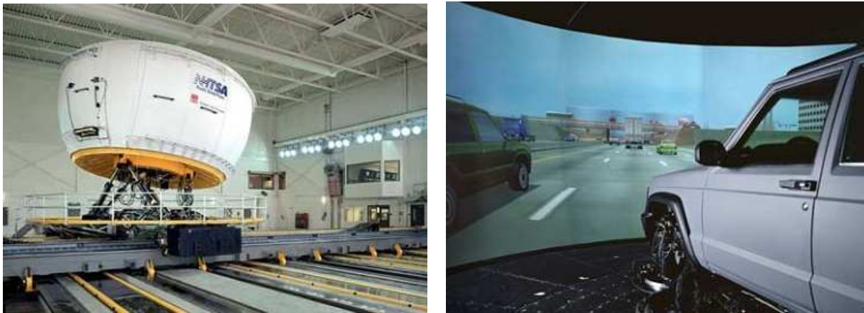
Figura 1 – NADS, à esquerda, a cabine e os dispositivos de movimentação, à direita, os componentes internos da cabine com um veículo monitorado e uma tela de projeção
