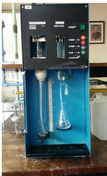
Figura 4.2. Destilador Kjeldahl
