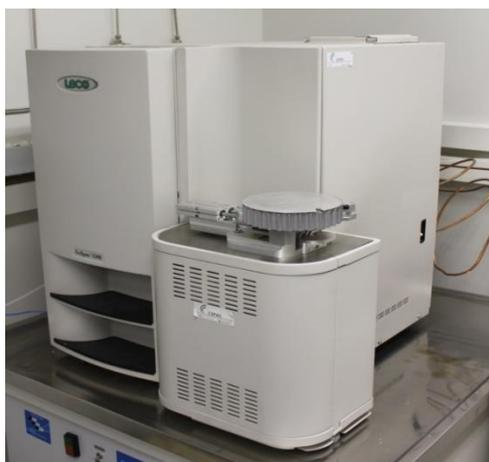
Figura 4.3. Analisador elementar TruSpec CHN
