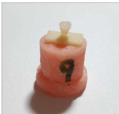
Figura 3 - Amostra após confecção do cone de cimento resinoso.
