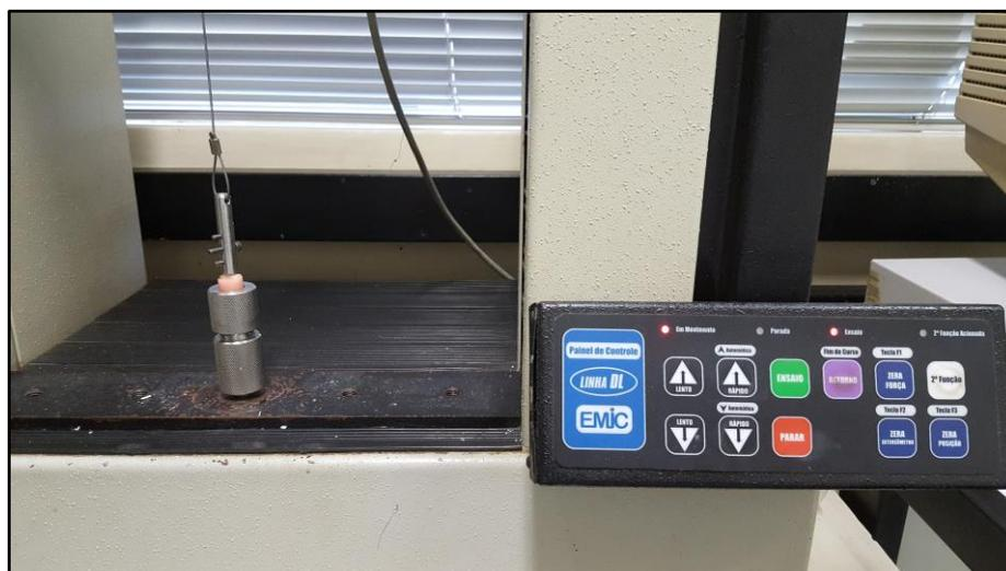
Figura 4. Ensaio de resistência à tração em uma máquina de ensaio universal.
