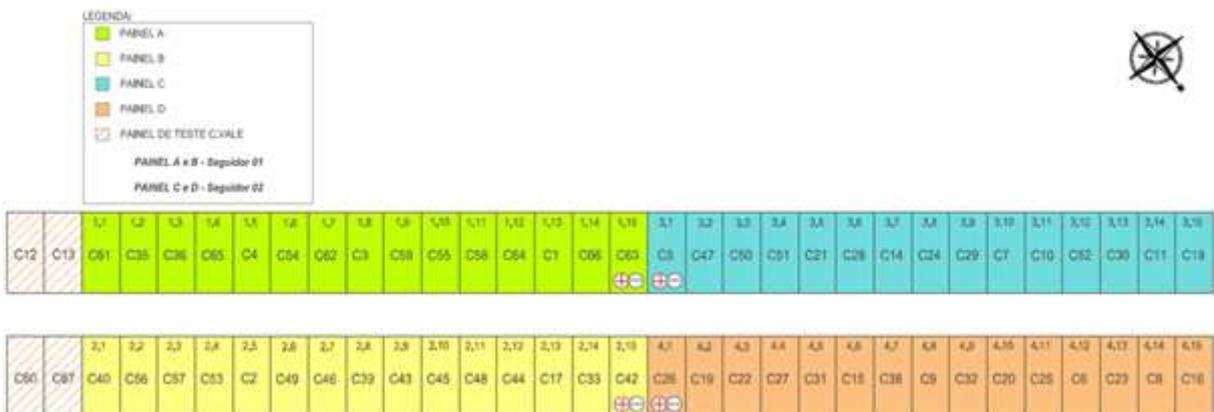
Figura 4.7. Distribuição dos módulos fotovoltaicos em cada painel para a instalação do sistema FV para a propriedade rural cooperada da C.Vale. Cada cor identifica um painel com os módulos conectados em série.
