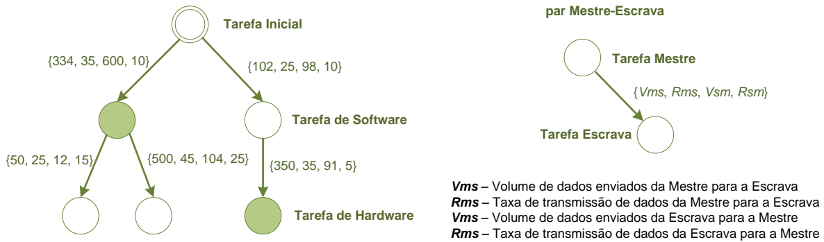
Figura 1 – Exemplo de aplicação modelada por um grafo de tarefas [CAR10].
