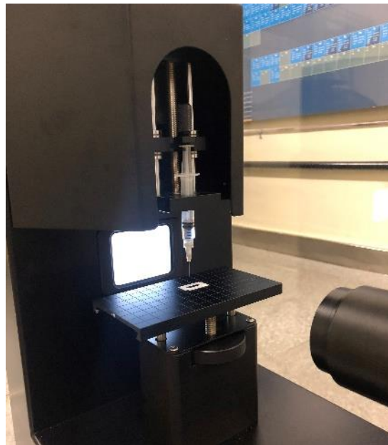
Figura 6 - Seringa adaptada para técnica da gota séssil, com marcação para posicionamento do corpo- de-prova
