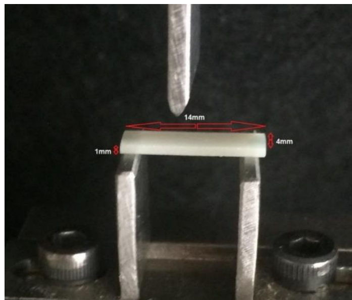
Figura 10 - Barra com dimensões posicionadas para o ensaio mecânico.
