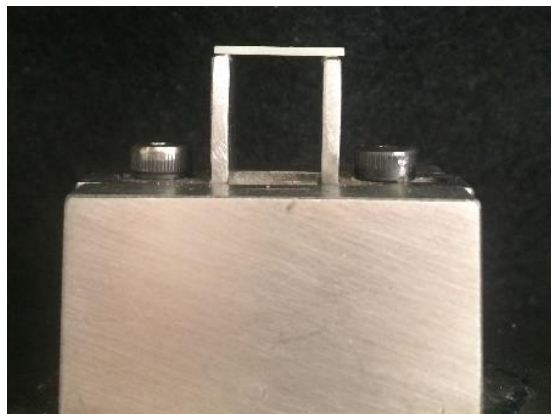
Figura 8 - Barra posicionada perpendicularmente às hastes da matriz em vista lateral.
