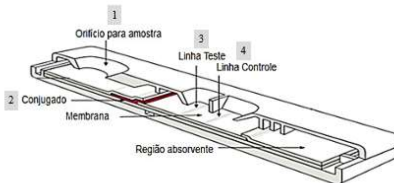
Figura 1. Representação esquemática da estrutura de um dispositivo de imunocromatografia de fluxo lateral. Fonte: Adaptado do manual do teste rápido Millipore.
