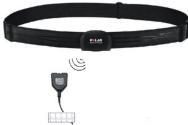
Figura 60. Dispositivo 31 , em formato de cinto, que transmite os sinais da HR para um sensor de ECG.
