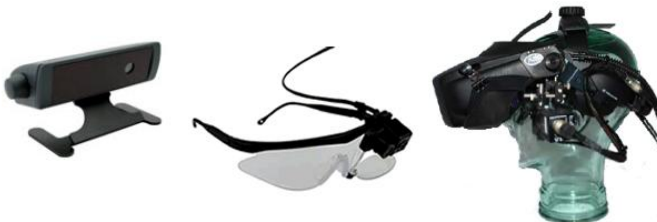
Figura 8. Exemplos de dispositivos de rastreamento de olhar [ASL10].
