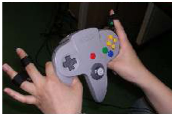
Figura 13. Disposição dos sensores de biofeedback e gamepad utilizado no experimento (adaptado de Lin et al [LIN06a]).
