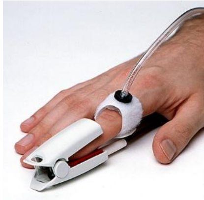
Figura 4. Exemplo de fotopletismógrafo [KIR02].
