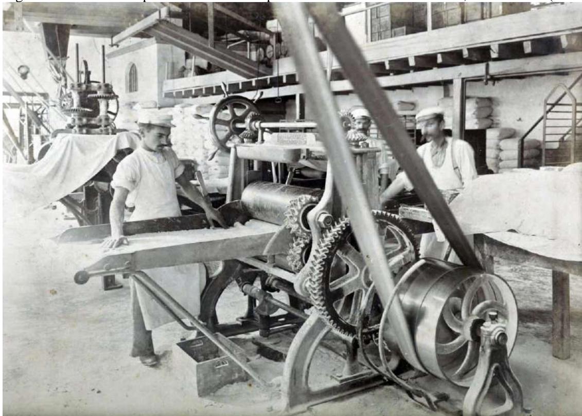
Figura 39: Cilindro Josph Baker and Sons para abrir massa na Fábrica Leal, Santos & C. (1910).
