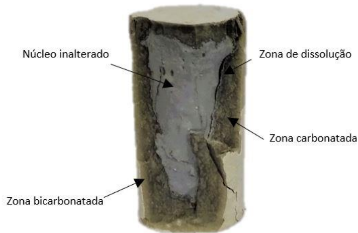
Figura 5.10. Imagem da amostra MP 0,5% ( n\text{-Al}_2\text{O}_3 ) reagido com \text{CO}_2 e após ensaio de resistência à compressão ilustrando o mecanismo de fratura.
