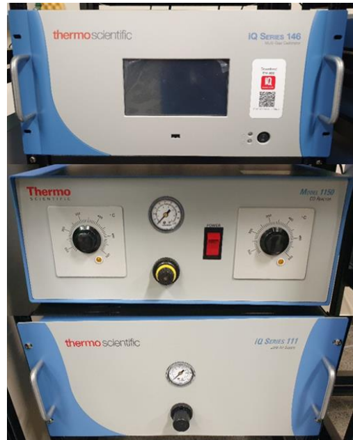
Figura 4.1 Módulo de controle e diluição (iQ 146), purificador do ar (1150) e gerador de ar zero (iQ 111).
