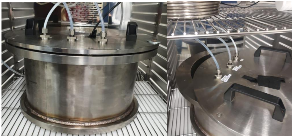
Figura 4.7 Câmara interna onde o monitor de baixo custo foi acondicionado para a calibração e a avaliação de parâmetros de desempenho dos seus sensores de baixo custo.
