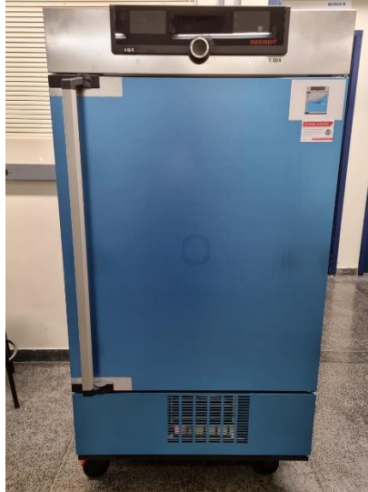
Figura 4.3 Câmara Climática (ICH260L – Memmert) utilizada nos experimentos que demandam variação de temperatura.
