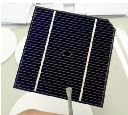
Figura 3.2: Célula solar bifacial desenvolvida em lâminas de silício (a) do fabricante A com resistividade de base de 0,8 \Omega .cm a 2,6 \Omega .cm e (b) do fabricante B com resistividade de base 1 \Omega .cm a 20 \Omega .cm.
