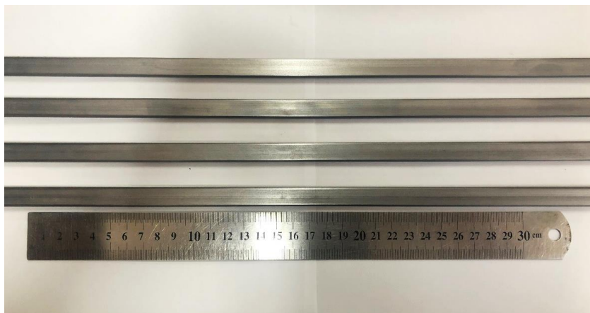
Figura 4.1 – Amostras de aço utilizadas nos testes de corrosão, como recebidas, com dimensões de bitola 12x5 mm.
