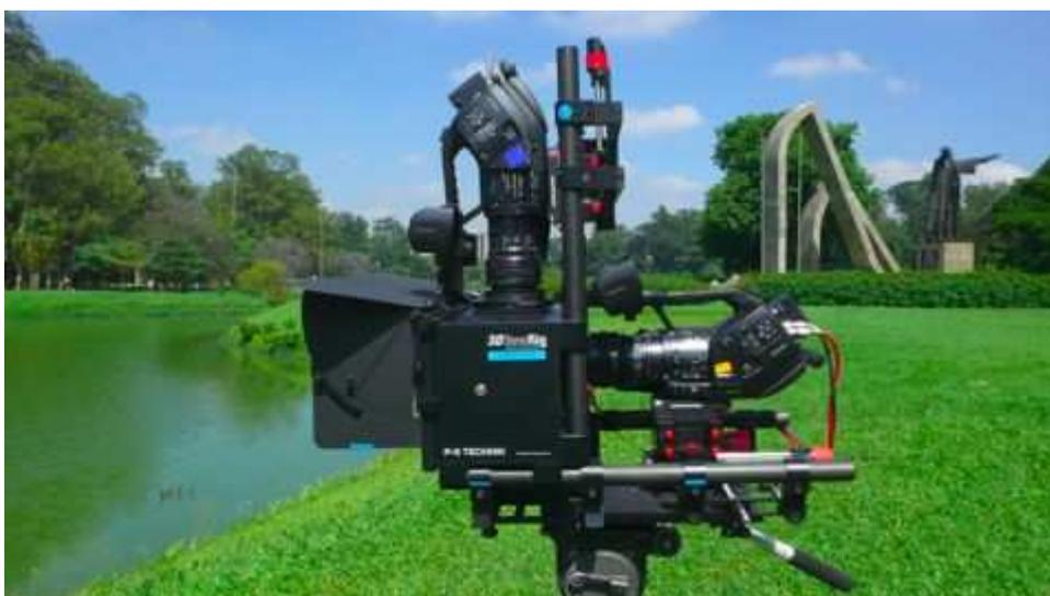
**Figura 15 – FOTO DAS CÂMERAS SONY EX3 USADAS NA PRODUÇÃO DE LONGA 3D**
