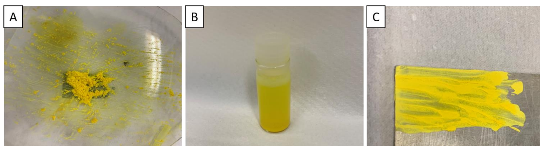
Figura 5.7. Características de Bz-P: (a) forma da resina, (b) solubilidade em água e (c) aplicação em substrato de aço carbono.
