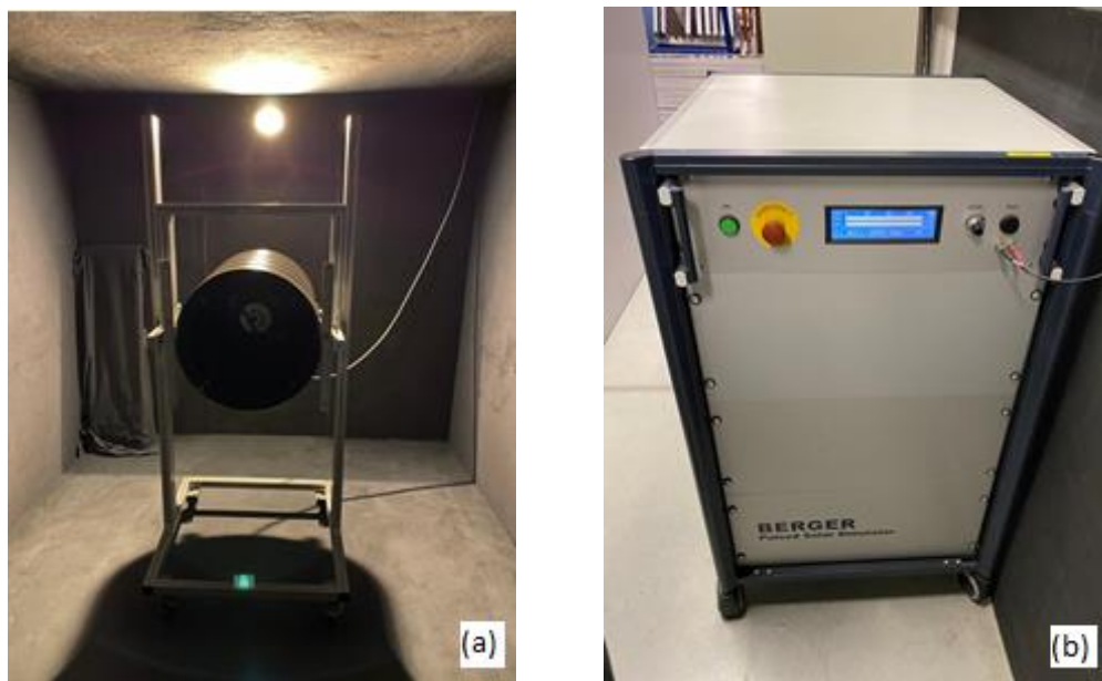
Figura 15 – (a) Suporte com a lâmpada xenônio e (b) fonte de tensão elétrica do simulador solar PSS8 produzido pela empresa BERGER Lichttechnik GmbH & Co. KG.
