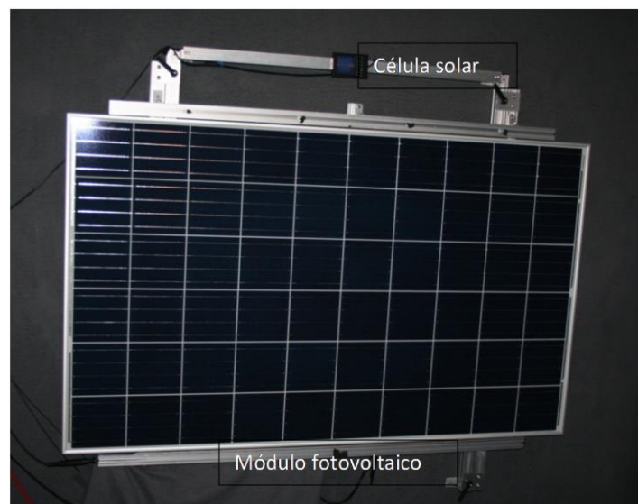
Figura 16 – Estrutura de fixação dos módulos fotovoltaicos na câmara de medição da curva I-V.
