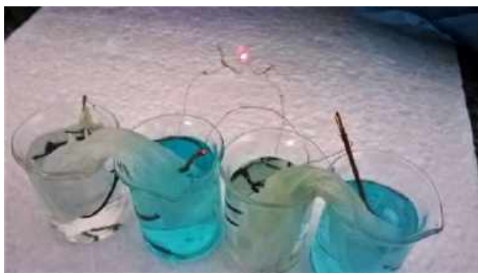
FIGURA 07: Pilha de Daniell, construída por um grupo de alunos, com a respectiva lâmpada de LED acesa.
