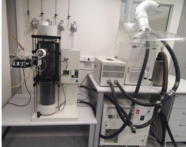
Figura 4.2. Nano *spray dryer* B-90 HP.
