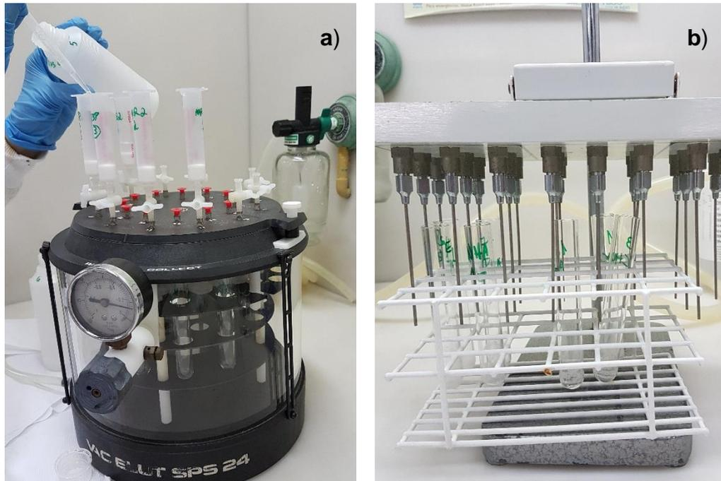
Figura 4.5. (a) Sistema de vácuo. Cartuchos C18 (contendo sílica) para a etapa de microextração dos herbicidas. (b) Processo de secagem em fluxo de ar comprimido (SOARES, 2019).
