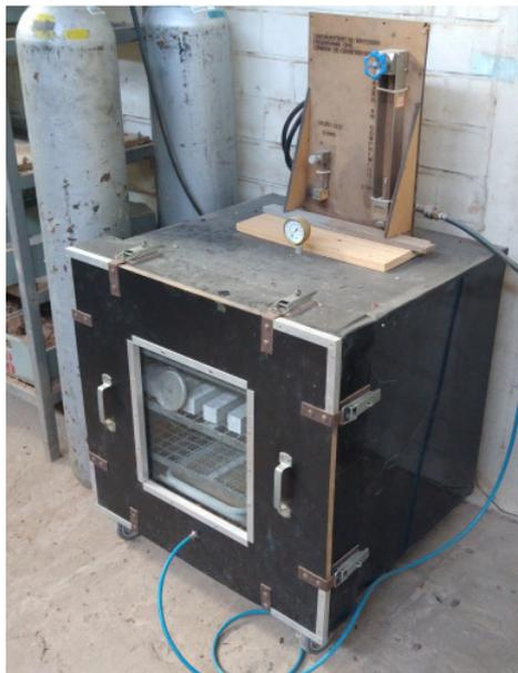
Figura 4.8 - Câmara de carbonatação acelerada.
