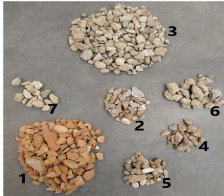
Figura 4.1 - Composição gravimétrica do agregado graúdo reciclado.
