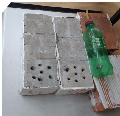
Figura 4.4 - Corpo de prova após execução de furo para coleta de material pulverulento.
