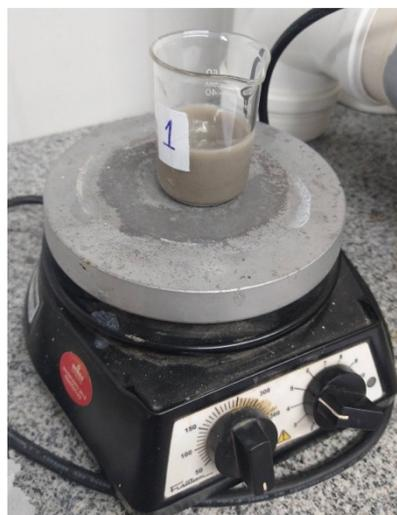
Figura 4.6 - Amostra de pó de concreto no agitador magnético.
