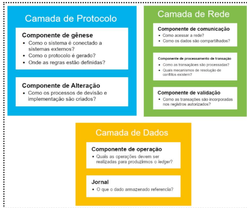
Figura 3 – Diagrama de representação simplificada da camada de dados de DLTs
