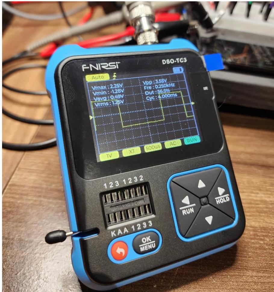
Figura 11 - Osciloscópio Recebendo o Sinal PWM do Servomotor 4 com posição em 90°
