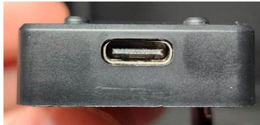
Figura 3 - Conexão USB-C ESP32 TTGO
