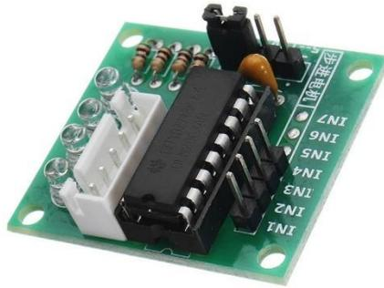
Figura 7 - Driver ULN2003. Fonte:
