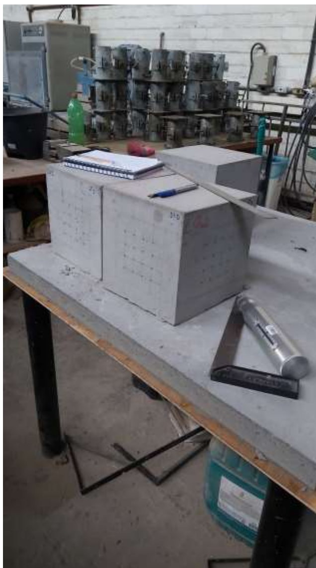
Figura 3 – Fixação dos cubos no ensaio esclerométrico.
