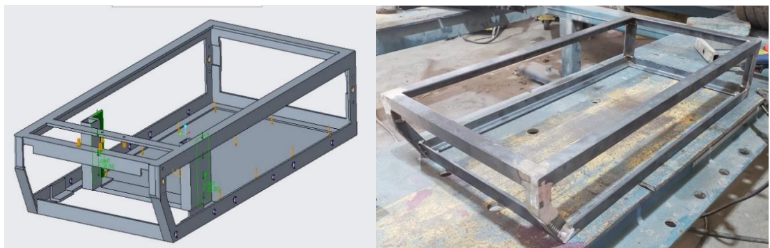
FIGURA 4-modelo 3D do chassi (à esquerda) e chassi durante sua construção(direita)
