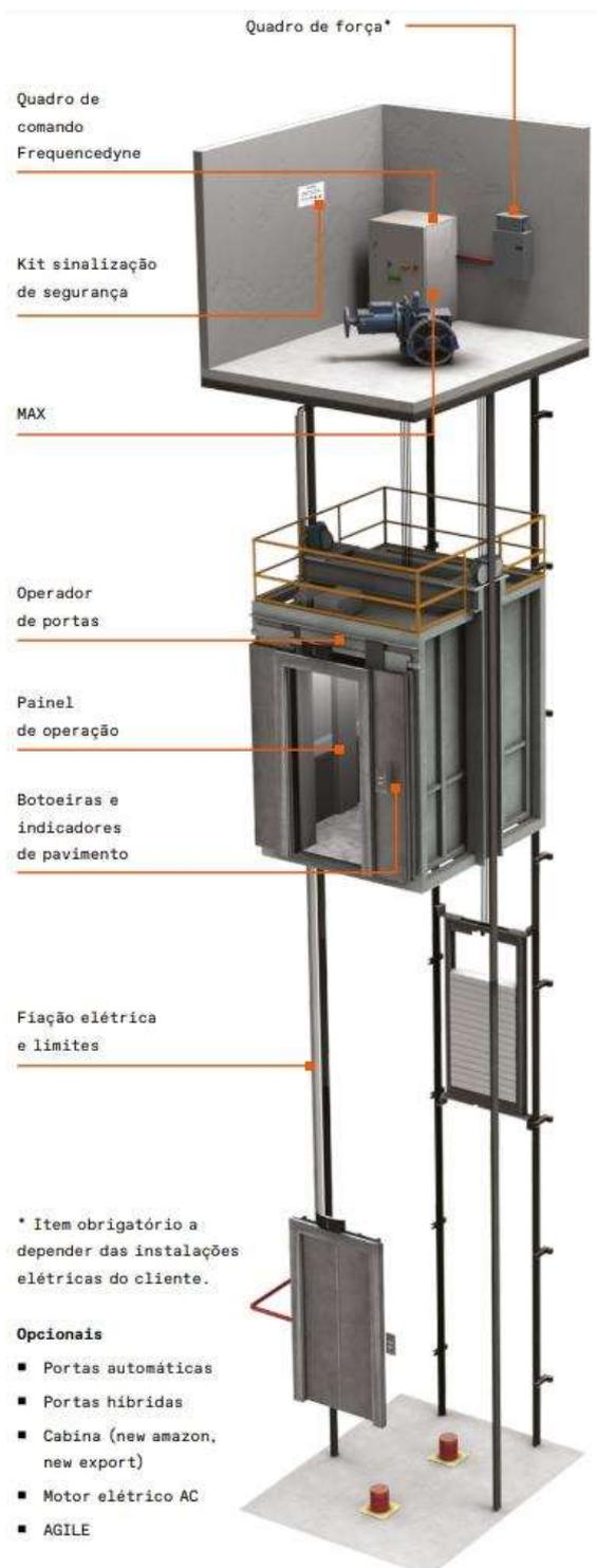
Figura 1: Componentes do elevador (TK Elevator, 2024)
