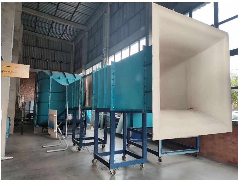
Figura 8. Túnel de vento utilizado para testes
